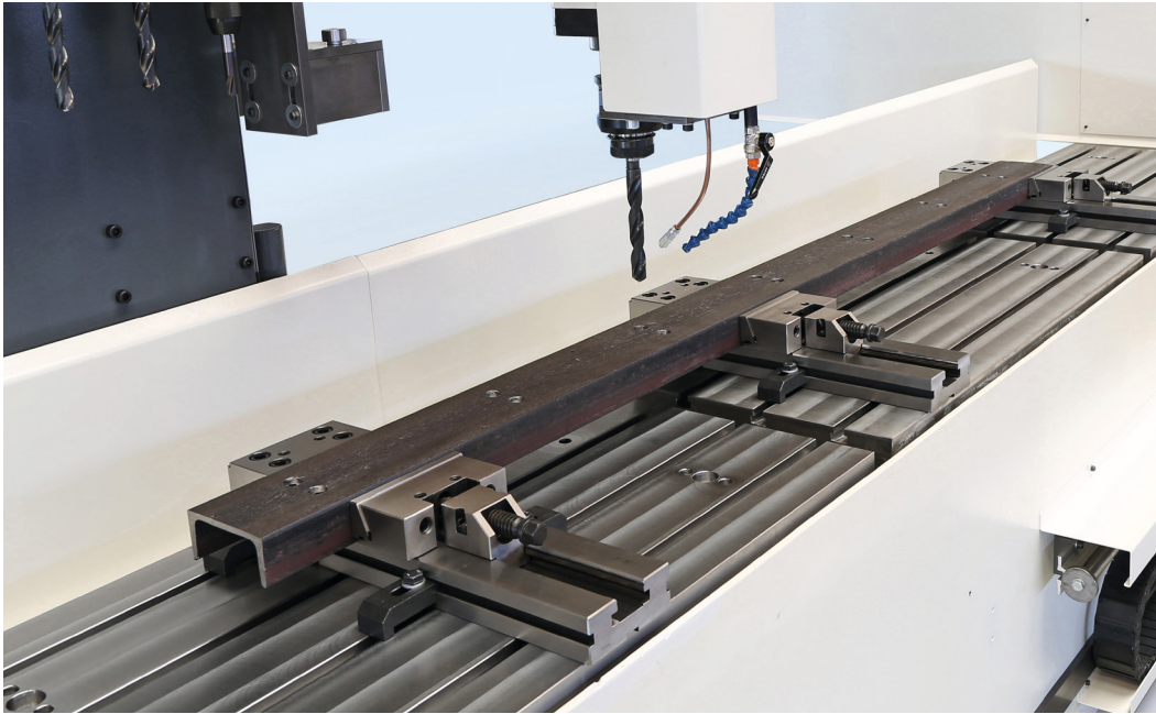
Aufspannbeispiel von langen Teilen durch mehrere Schraubstöcke
