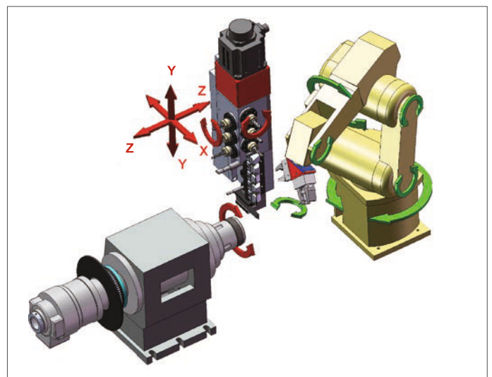
Схема рабочей зоны iRobo
